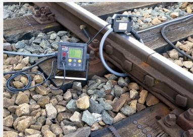
El equipo especialmente posibilita encontrar cortocircuitos, interrupciones de contacto y resistencias de transición, p. ej. en el aislamiento de los carriles, enlaces, vástagos del distribuidor, cables de puesta a tierra, juntas de carril aislante y circuitos de vía con junta eléctrica de separación.
