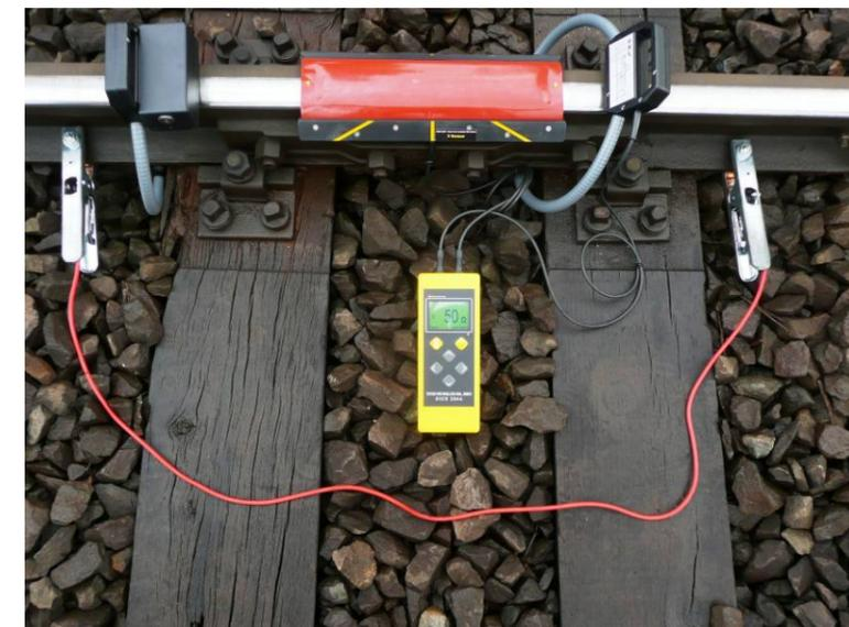
Fig. 3.2 SICO 2046 con corto-circuito paralelo
