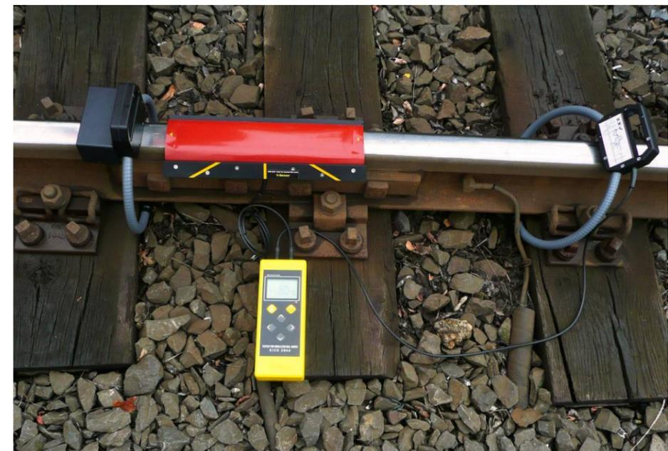
Fig. 3.5 C-sensor detrás del próximo conductor de desvío
