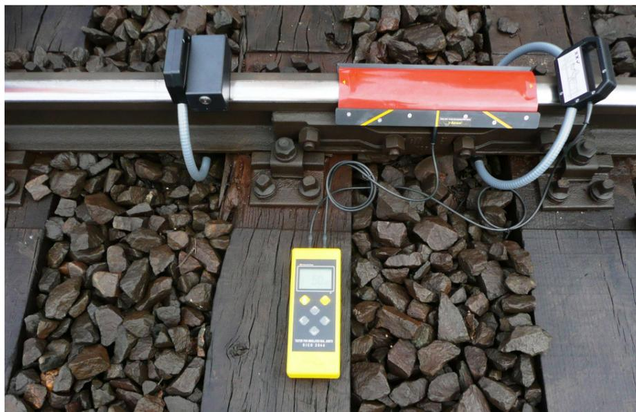
Fig. 3.6 C-sensor encerra el carril y la junta aislante
