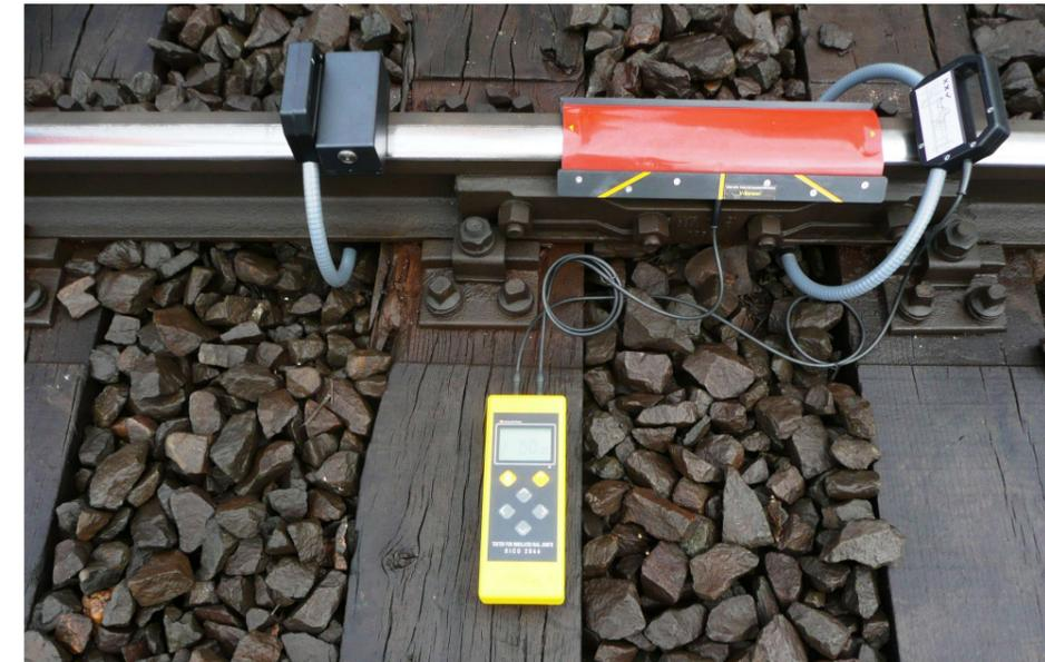
Abb. 3.8 C-sensor encierra el carril y la junta aislante
