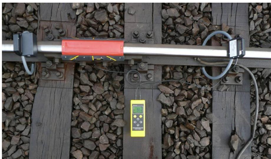
Fig. 3.7 C-sensor encerra el carril y un conductor
