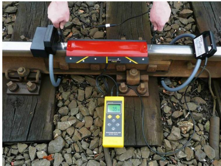
Fig. 3.3 Contactar el resistor 33 Ohm
