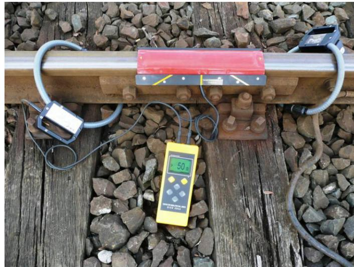
Fig. 3.1 Construcción de SICO 2046 al carril
